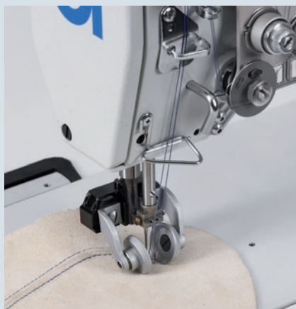
Wulstnaht im Blattbereich Cording seam on vamp
