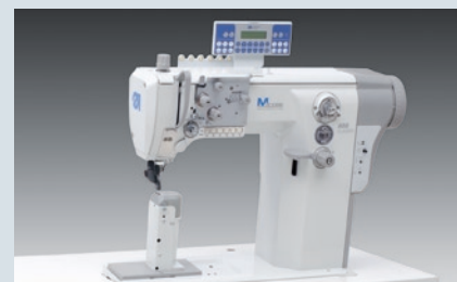
Dürkopp Adler 888-M - Ein- und Zweinadel-Säulenmaschine mit integriertem Direktantrieb für den Einsatz im mittelschweren Anwendungsbereich
