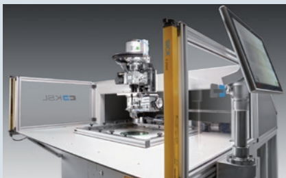
KL 351 - Frei-programmierbare Nähanlage mit Drehkopf für aufwändige Zier- und Montagenähte (bis 1000 x 1000 mm)
