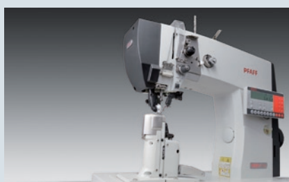
PFAFF 1571-725 - Elektronische Einnadel-Säulenmaschine (Säule links) mit Unterschneideinrichtung
