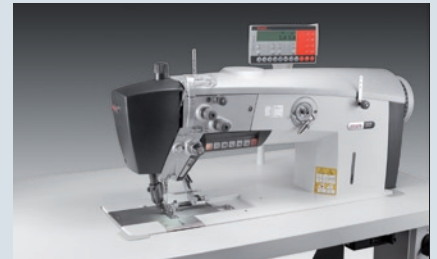
PFAFF 2521 - Einnadel-Spezialschnellnäher mit Nadeltransport, Differentialtransport, elektr. Schiebrad und angetriebener Rollfuß
